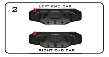
2.) USE A PHILLIPS SCREW DRIVER AND REMOVE ONE SCREW ON EACH SIDE OF THE END CAP. PLEASE SEE FIGURE 2 ON THE LEFT.
