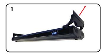
1.) POSITION THE UNIT UPSIDE DOWN. REMOVE THE HEX SCREW ON THE LEGS. POSITION THE LEGS WHERE THE FLAT SIDE IS FACING OUTWARDS AND ALIGN THE LEG TO THE BRACKET. PLEASE SEE FIGURE 1 ON THE LEFT.
